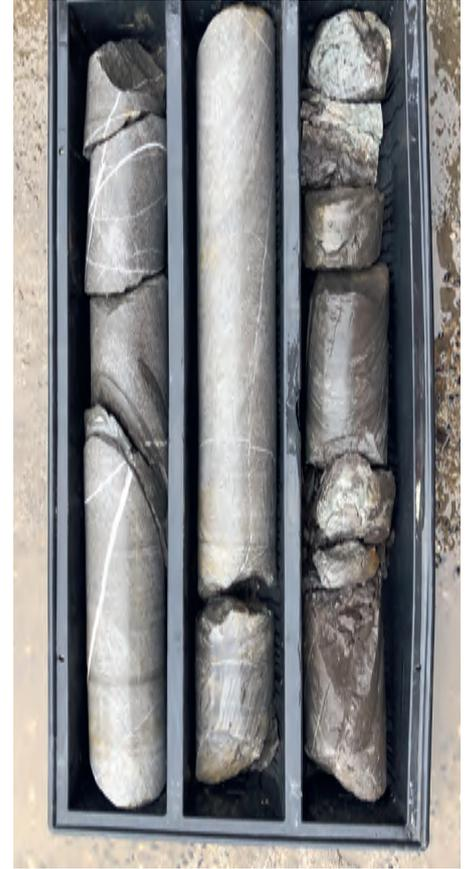
Hohe Bohrkern Qualität. Doppelkernrohr auch im Lockergestein.
