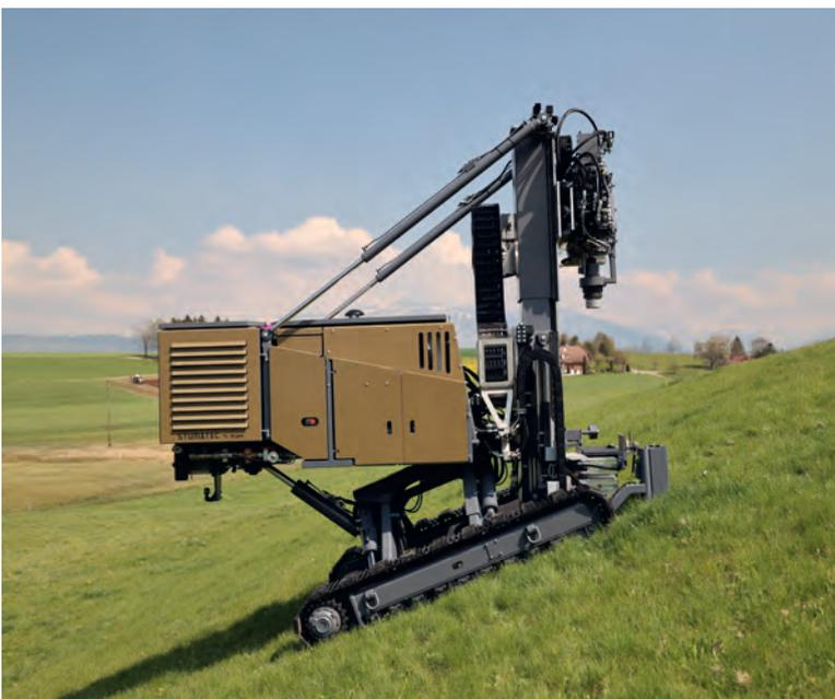
Unebenes Gelände bis 35° kann mit Fahrwerk nivelliert werden.
